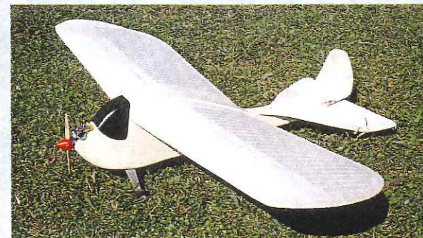
↑機体名…(3号機) テネモス・チョコビー 設計の狙い…狭い場所でも飛ばせる小さな旋回半径をテスト 全長…1070mm, 全幅…1660mm, 全備重量…1100g, 主翼面積…71.3dm 2
