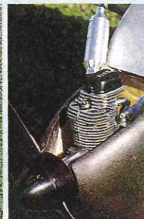
エンジン…ENYA 53-4 プロペラ…11×5 RC装置…3ch
