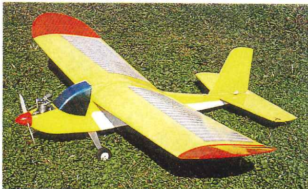
機体名…(5号機) テネモス・サーナ 設計の狙い…低空・低速旋回時における安定した飛行性能を確保する 全長…1350mm, 全幅…1800mm, 全備重量…2370g, 主翼面積…73.8dm 2
