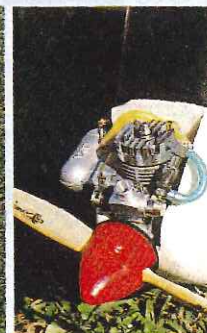
エンジン…ENYA11C X プロペラ…8×5 RC装置…3ch
