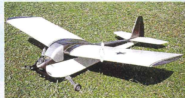
↑機体名…(2号機) テネモス・アラア 設計の狙い…主翼の付根から翼端までの振動数変化による飛行の違い 全長…1500mm, 全幅…1840mm, 全備重量…2450g, 主翼面積…77.2dm 2
