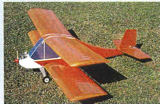
↑機体名…(1号機) テネモス・フグ 設計の狙い…小さなエンジンで大きな抵抗の機体が飛ぶか? 全長…1480mm, 全幅…1800mm, 全備重量…1580g, 主翼面積…61.2dm 2
