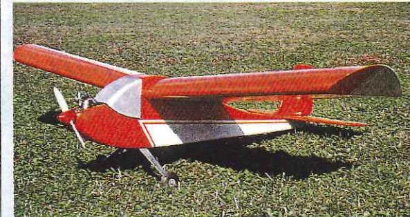
↑機体名…(4号機) オエステ 設計の狙い…強風および微風のいずれでも優れた飛行安定を実現させる 全長…1530mm, 全幅…2060mm, 全備重量…3200g, 主翼面積…94.7dm 2
